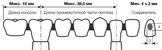
Рисунок В. Требования к размерам мостовидных протезов Zirconia Implant Bridge
