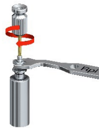
Figur I: Använda Combined Open-end Wrench för att hålla fast Implant Mount
