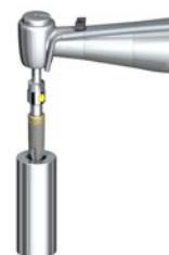
Захватите имплантат, находящийся во внутреннем цилиндре, с помощью имплантантоудаляющего инструмента.
