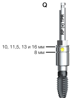
Рисунок Q. Схема соответствия длины метчика хирургии по шаблону Guided Screw Tap и имплантата
