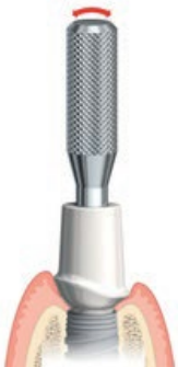
Figur C: Lossa distansen genom att vicka på Abutment Release Pin CC
