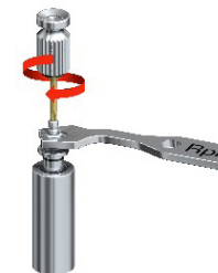
Рисунок I. Использование ключа для извлечения имплантовода Combined Open-end Wrench для удержания имплантовода Implant Mount
